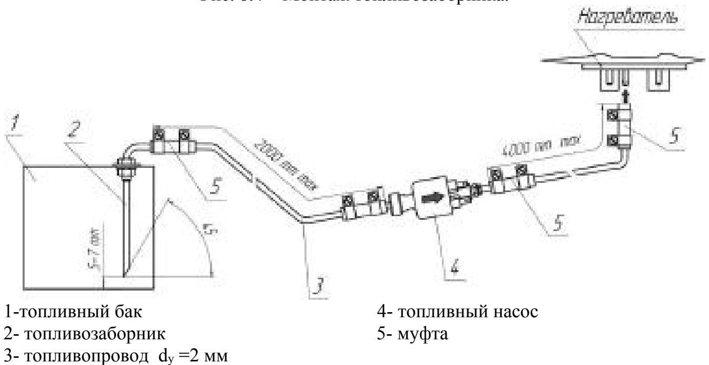
Рис. 8.4 – Монтаж топливозаборника.
